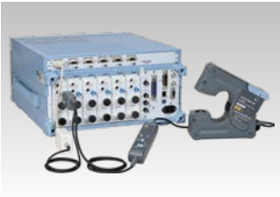
设备连接示例： CT1000S、761961与WT1800R
